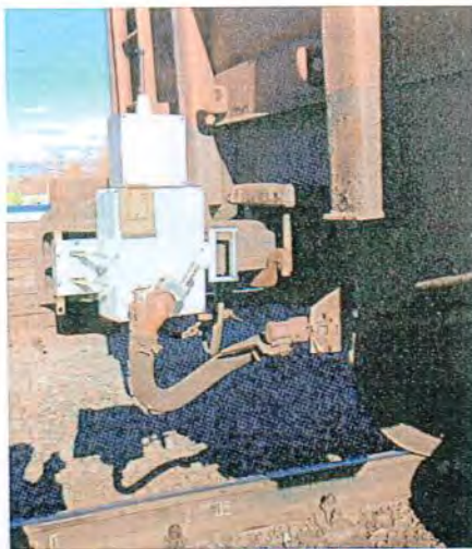
Рис. 20. Блок хвостового вагона, закрепленный на последнем вагоне грузового поезда
