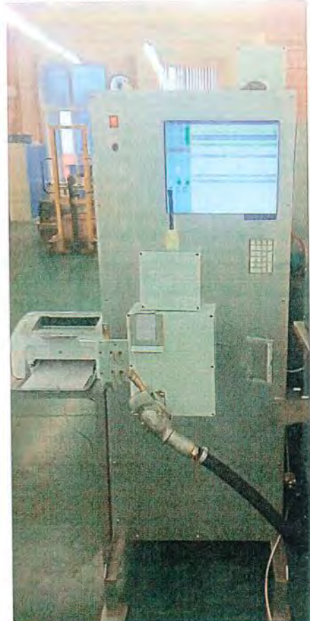
Рис. 22. Стенд с регистрацией параметров для проверки БХВ
