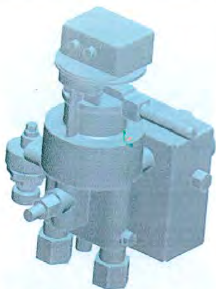
Рис. 5. Кран машиниста 395М-06 с установленными на нем электропневматическим блоком 204 и контроллером 395.370-1
