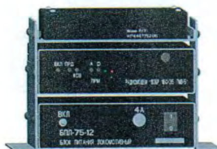
Рис. 8. Модемы РУТП А174.467752.015, 1Р23С/В «ВЭБР 160/35» и локомотивный блок питания БПЛ-75-12 в сборе
