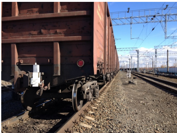
Фото.2. Блок хвостового вагона закреплен на последнем вагоне грузового поезда
