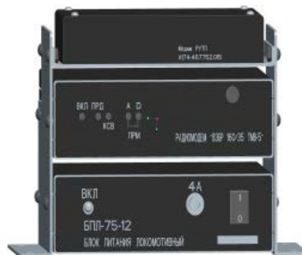
Рис.8. Модемы РУТП А174.467752.015, 1Р23С/В "ВЭБР 160/35" и блок питания локомотивный БПЛ-75-12 в сборе.
