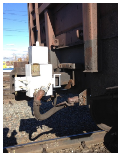
Фото.2. Блок хвостового вагона закреплен на последнем вагоне грузового поезда
