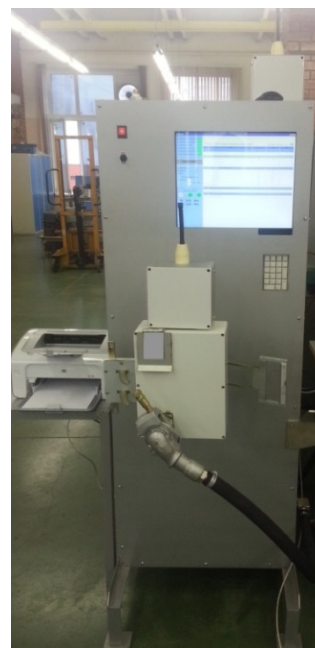
Фото 4. Стенд с регистрацией параметров для проверки БХВ.
