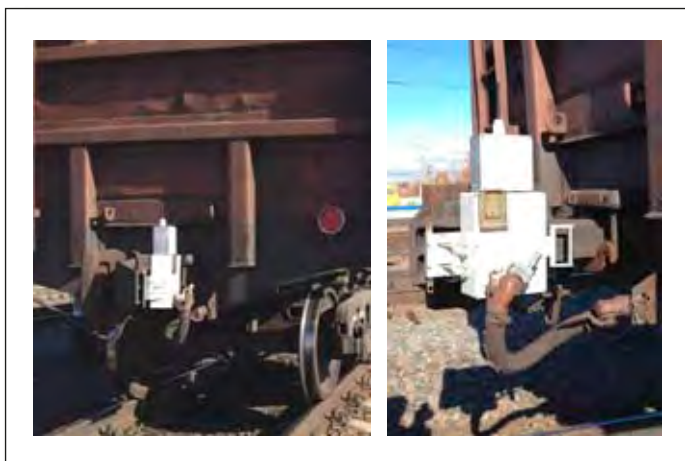
Рис. 20. Блок хвостового вагона, закрепленный на последнем вагоне грузового поезда
