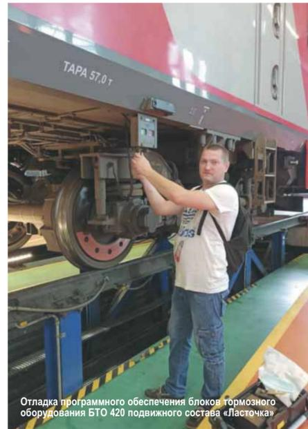
Отладка программного обеспечения блоков тормозного оборудования БТО 420 подвижного состава «Ласточка»
