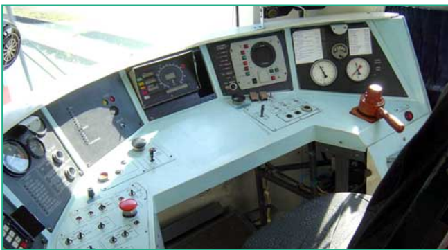
Рельсовый автобус РА1: пульт управления машиниста и общий вид автобуса
