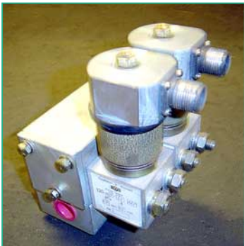
Рис. 8. Блок управления стояночным тормозом № 192
