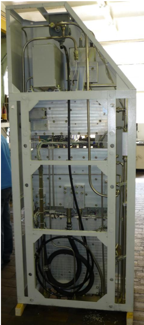
Рис. 2. Модуль тормозного оборудования Е.311 (вид сзади)
