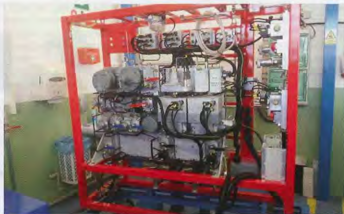
Рис. 4. Исполнительный блок модуля тормозного оборудования Е.315 в каркасе производства компании «СZ LOKO» на тепловозе ЧМЭЗМ-4628
