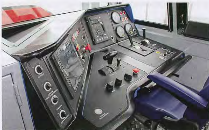
Рис. 3. Контроллеры крана вспомогательного тормоза и крана машиниста, а также резервный пневматический модуль в пульте машиниста
