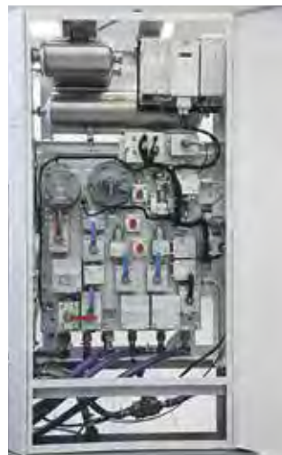
Модуль тормозного оборудования Е.311КМ
