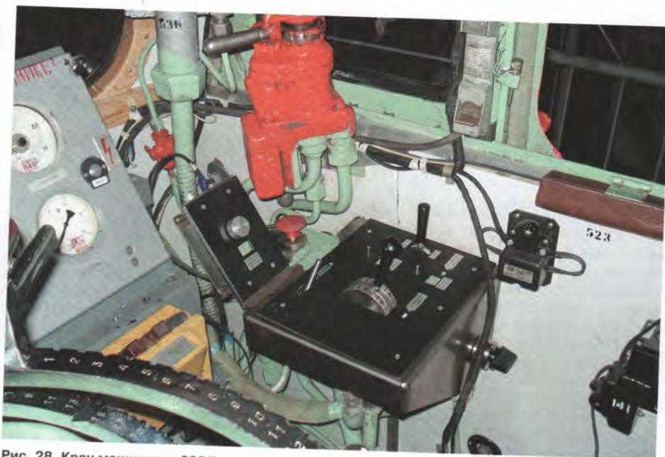
Рис. 28. Кран машиниста 230Д на электровозе ВЛ10-269 (семипозиционный и трехпозиционный контроллеры, электронный редуктор, клапан аварийного экстренного торможения, выключатель цепей управления)
