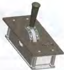
Рис. 3. Семипозиционный контроллер: I — сверхзарядка; II — поездное; III — перекрыша без питания; IV — перекрыша с питанием; VA — замедленное торможение; V — служебное торможение; VI — экстренное торможение
