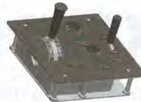
Рис. 5. Совмещенные семипозиционный и трехпозиционный контроллеры под одной панелью расширяют возможности проектирования тормозной системы конкретного локомотива
