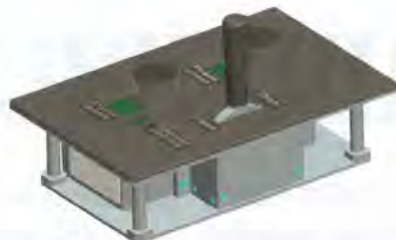
Рис. 4. Трехпозиционный контроллер имеет позиции: отпуск; нейтральная позиция; тормоз. Позиции отпуска и тормоз не фиксированы, с самовозвратом в фиксированную нейтральную
