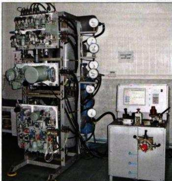
Электронно-пневматический стенд проверки унифицированного комплекса тормозного оборудования грузовых локомотивов К-УКТОЛ-Г
