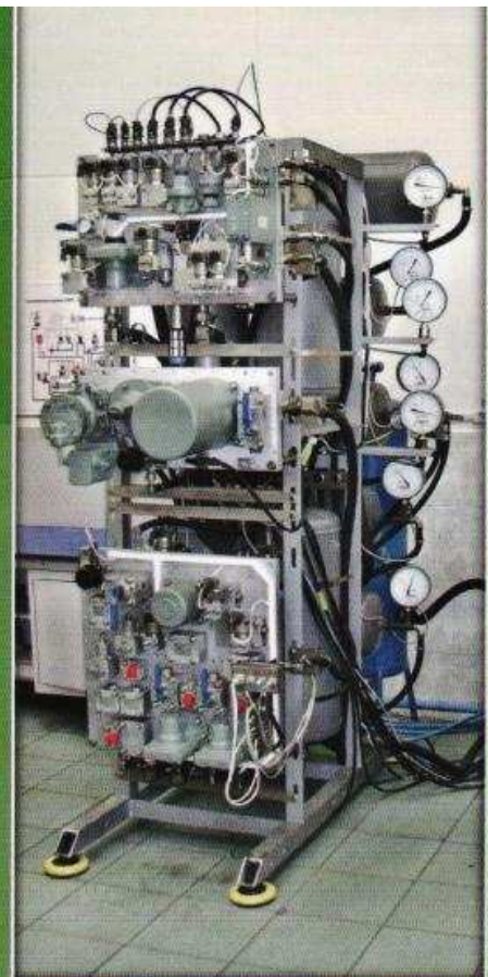
Стойка электронно-пневматического стенда
