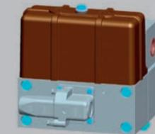
Клапан сбрасывающий трехпозиционный предназначен для сброса давления сжатого воздуха из тормозных цилиндров по командам БАРС 6М с возможностью фиксации промежуточных значений давления, а также с последующим их наполнением
