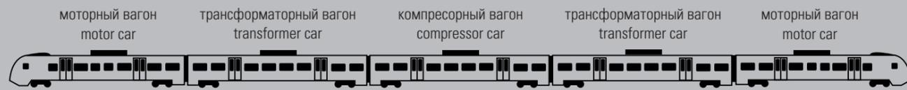
Максимальная составность электропоезда ЭС2Г 5 вагонов. Допускается объединение электропоездов по схеме 5+5.
