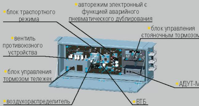
Блок тормозного оборудования 072 применяется на вагонах метрополитена с конструкционной скоростью движения 90 км/ч эксплуатирующихся в тоннелях на действующих линиях метрополитена и на открытых участках пути, оборудованных нижним расположением контактного токоподводящего рельса.
