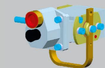
Клапан срывной 370 (КС 370) предназначен для обеспечения автоматической экстренной разрядки тормозной магистрали, при проезде поездом запрещающего путевого сигнала, а также при превышении установленной скорости движения поезда на участках, оборудованных инерционными путевыми шинами.
